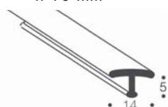
Coprigiunto per pavimenti h 5 mm
