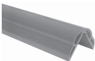
Paraspigolo in gomma morbida antiurto (esterno 50x50) - (interno 35x35) mm spessore gomma 3 mm
